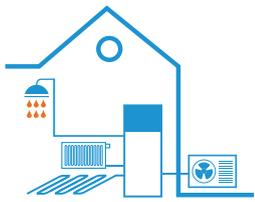
DAIKIN Altherma 3 R F kombiniert einen Edelstahl-Trinkwasserspeicher und eine Luft-Wasser-Wärmepumpe in einem Gerät. Ideal für Heizen, Kühlen und Trinkwassererwärmung.
